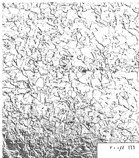
شکل (۹) ساختار میکروسکوپی نوری نمونه کار سرد شده و پیر شده در 1100^{\circ}\text{C} به مدت ۳۰ دقیقه
