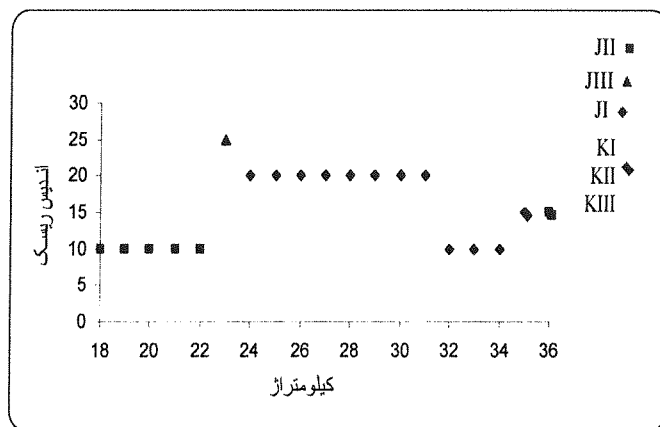
شکل (۳): ریسک موجود و برخورد با زون های مچاله شونده در تونل قمرو
