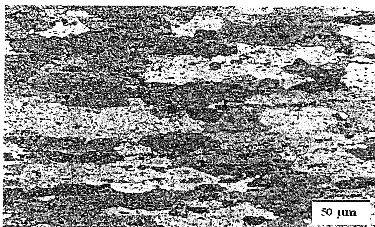
شکل (۵): ساختار میکروسکوپی آلیاژ ۳۰۰۳ در حالت آنیل.
